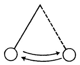
Ein sogenanntes Faden- oder Mathematisches Pendel besteht aus einen Körper, der an einem möglichst dünnen Faden der Länge I aufgehängt ist. Lenkt man den Körper aus der Gleichgewichtslage aus und lässt ihn los, so beginnt er zu schwingen. Als Schwingungsdauer T bezeichnet man die Zeitspanne, die der Körper benötigt, um einmal z.B. vom höchsten Punkt auf der linken Seite bis wieder zu diesem Punkt zu schwingen. Die Messung von Schwingungsdauer und Fadenlänge ergab die folgende Wertetabelle:
